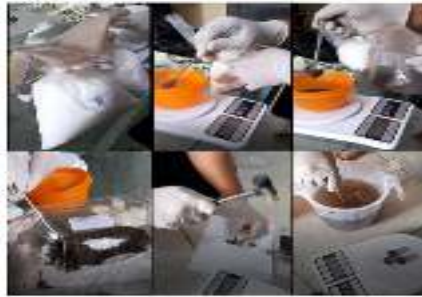
Gambar 1. Proses pembuatan tablet cepat larut (effervescent) dari kompos kulit buah kakao Hasil Uji Produk
